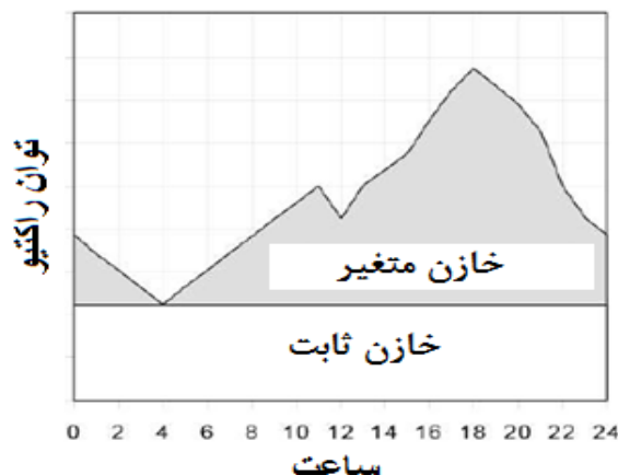
شکل ۱۵- جبران سازی توان راکتیو توسط خازن های ثابت و متغیر
